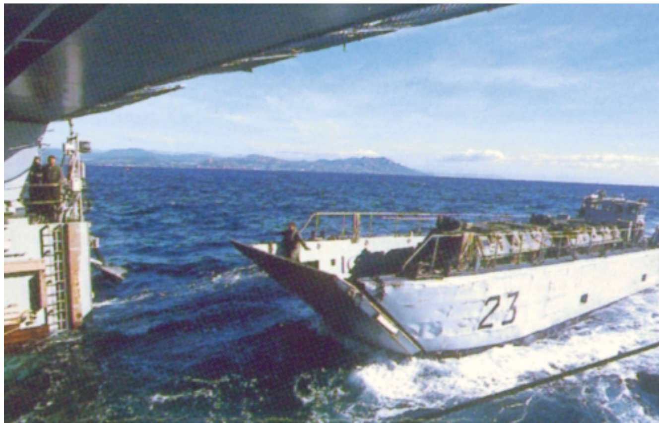
Sortie d'un CTM du radier d'un TCD (Sirocco)
